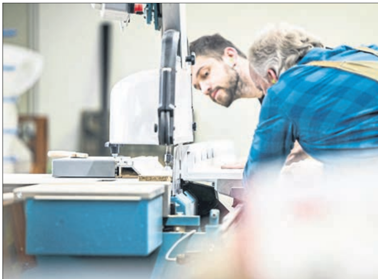
An dieser Formatkreissäge wird gerade eine Schrankverkleidung besäumt.
